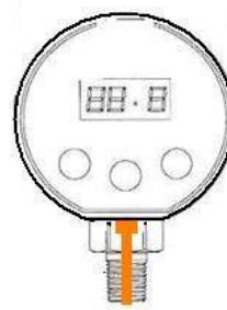
極端な例で説明しますと、ヘッドスペースが2.0mlsで容器内真空度が-50Kpaのサンプルをブルドン管の容積が2.0mlsの真空圧力計で測定すると、読値は-25Kpaと元の真空度の半分になってしまいます。
