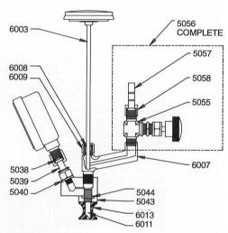
シリーズ6000ピアシングデバイスはガラス瓶・ペットボトル・缶を問わず、炭酸飲料のガスボリュームをテストする器具です。デュアルスケール圧力計(0-60 psi & 0-4.2kg/cm2)と調節可能な2インチのダイアル温度計(25/125°F & -5/55°C)を装備しており、また、1リットル用と3リットルまで測定できるタイプがあります。6000シリーズのピアシングデバイスでは、付属のチャートを使ってガスボリュームを換算する必要がありますが圧力計、温度計をDGV-1に変える事により14000シリーズと成り、より簡単に精度良くガスボリュームを測定することができます。
