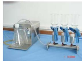
★ 每个 3 联抽滤装置均可通过连接装置串联起来.
