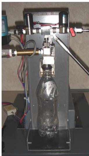
**BQSL** 高汽体含量同步混比设备是由高质量的碳酸混比罐和全自动站立式单独灌注头组成。
